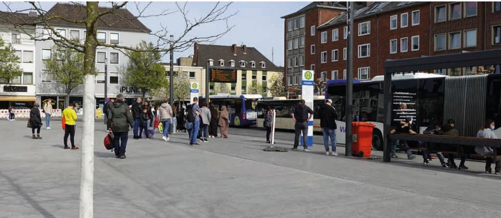
Hohe Granitbordsteine garantieren den barrierefreien Zu- und Ausstieg. Durch taktile Leitelemente werden Sehbehinderte zu den Haltestellen und innerhalb des Wartebereiches geführt.
