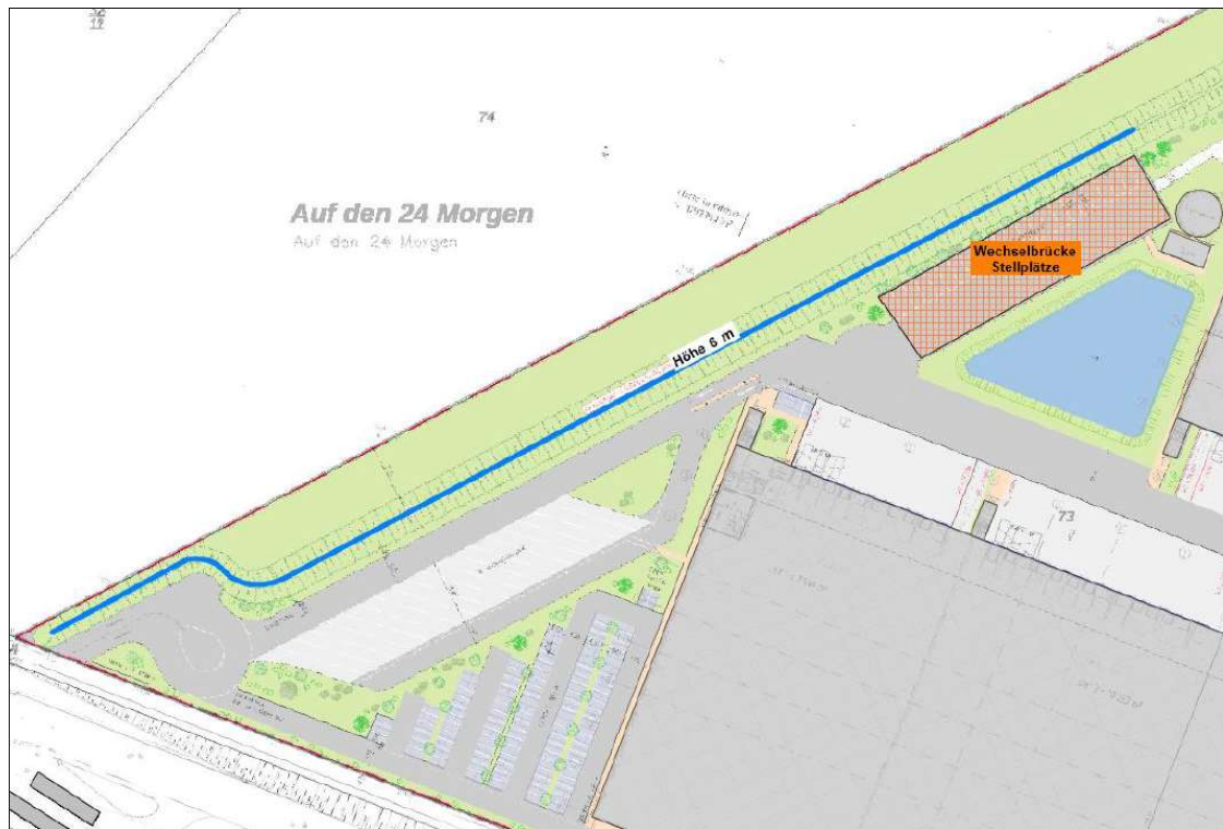
Abb. 7: Lage der Schallschutzwand (blau) und der Wechselbrücken. Aus: Immissionsschutz-Gutachten. Schalltechnische Untersuchung zur Ansiedlung eines Gewerbegebietes (Multi-User-Center) in Düren. NORMEC UPPEKAMP 2023.
